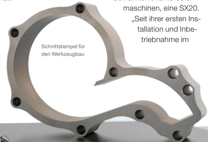
Schnittstempel für den Werkzeugbau
